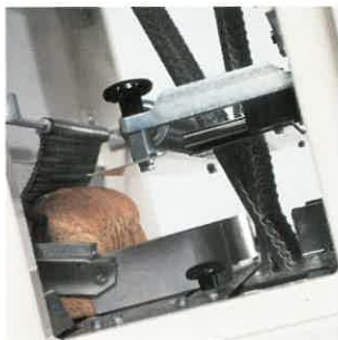
Messerschienen aus gehärtetem Stahl gewährleisten eine gleichmäßige Schnittstärke Jede gewünschte Schnittstärke lieferbar
