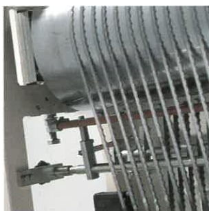
Maschine serienmäßig mit Schärfvorrichtung, wodurch die Lebensdauer der Messer verlängert wird
